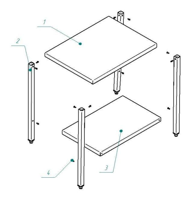
Рис. 1б схема сборки столов из нержавеющей стали. 1–столешница, 2–ножка, 3–нога опорная, 4–полка, 5–болт М6.
