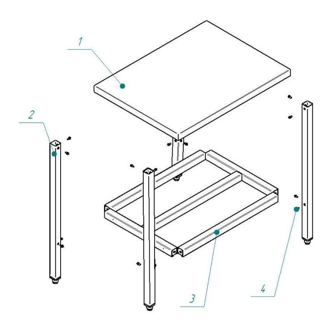
Рис. 1а схема сборки крашеных столов. 1-столешница, 2-ножка, 3-нога опорная, 4-основание, 5-Болт М6.
