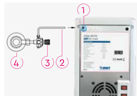
Рис. 11: Подключение баллона со сжатым CO 2
