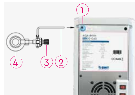
Fig. 11: Ligar a garrafa de gás comprimido de CO 2
