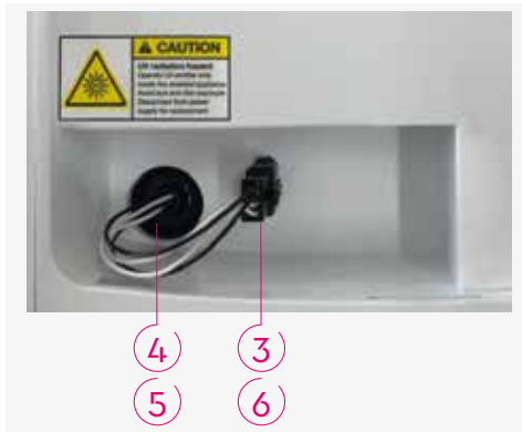
Fig. 12: Hueco de la lámpara UV situado debajo de la cubierta de AQ drink Pro 20
