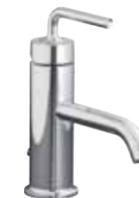
**E14402-4A-CP** Смеситель для раковины с гибкой подводкой. Ограничитель температуры. Ограничитель расхода воды: до 7,5 л/мин. Донный клапан. Высота 197 мм.
