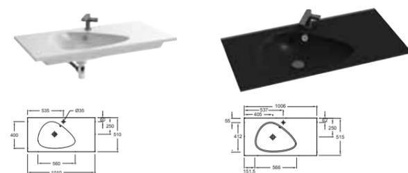
**EXAQ112-Z** Подвесная раковина-столешница с шлифованной нижней кромкой для установки на мебель. 101 x 51,5 см. 1 отверстие для смесителя. Керамическая заглушка.
