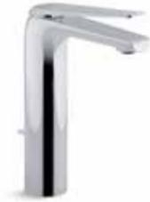
E97347-CP Высокий однорычажный смеситель для умывальника с гибкой подводкой. Высота под изливом 207 мм. Донный клапан. Максимальный расход воды 5 л/мин. E97347-ND-CP Без донного клапана
