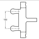
Спецификация продукта: Термостатический смеситель для ванны/душа. E10871. Коллекция: SINGULIER. BEC: 4,6 кг. ТИП: Термостатический. PACXOД ВОДЫ: 20 л/мин при давлении 3 бар. МЕХАНИЗМ: Новый уменьшенный термостатический картридж. PA3METKA ОТВЕРСТИЙ: 150 мм. СЛИВ: 0. ОДНОРЫЧАЖНЫЙ СМЕСИТЕЛЬ: ТЕРМОСТАТИЧЕСКИЙ ОДНОРЫЧАЖНЫЙ СМЕСИТЕЛЬ. УСТАНОВКА: 0. ГАРАНТИЯ НА ОТДЕЛКУ: 10 лет.
