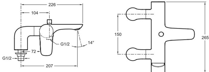
Спецификация продукта: Однорычажный смеситель для ванны/душа. E72283. Коллекция: ALEO. ВЕС: 3 кг. ТИП: Однорычажный. МЕХАНИЗМ: Керамический картридж. РАЗМЕТКА ОТВЕРСТИЙ: 150 ± 15 мм. СЛИВ: 0. ОДНОРЫЧАЖНЫЙ СМЕСИТЕЛЬ: МЕХАНИКА. УСТАНОВКА: 0. ГАРАНТИЯ НА ОТДЕЛКУ: 10 лет.
