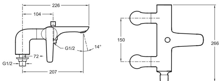
Спецификация продукта: Однорычажный смеситель для ванны/душа, E72320. Коллекция: ALEO+. ВЕС: 3 кг. ТИП: Однорычажный. РАСХОД ВОДЫ: 26 л/мин. РАССТОЯНИЕ МЕЖДУ ЦЕНТРОМ ИЗЛИВА И ЦЕНТРАЛЬНОЙ ОСЬЮ КОРПУСА: 208 мм. МЕХАНИЗМ: Керамический картридж. РАЗМЕТКА ОТВЕРСТИЙ: 150 ± 15 мм. СЛИВ: 0. МОДЕЛЬ СМЕСИТЕЛЯ ДЛЯ КУХНИ: Механика. ОДНОРЫЧАЖНЫЙ СМЕСИТЕЛЬ: МЕХАНИКА. УСТАНОВКА: На борт ванны. ГАРАНТИЯ НА ОТДЕЛКУ: 10 лет.
