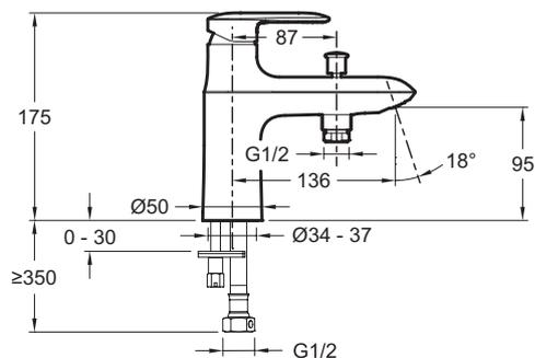
Спецификация продукта: Смеситель для ванны/душа. E99458. Коллекция: KUMIN. ВЕС: 1,6 кг. МАТЕРИАЛ: N/A. ТИП: Однорычажный. РАСХОД ВОДЫ: 20 л/мин. ВЫСОТА ПОД ИЗЛИВОМ: 175. РАССТОЯНИЕ МЕЖДУ ЦЕНТРОМ ИЗЛИВА И ЦЕНТРАЛЬНОЙ ОСЬЮ КОРПУСА: 132. ПОДКЛЮЧЕНИЕ: Установка на деку.
