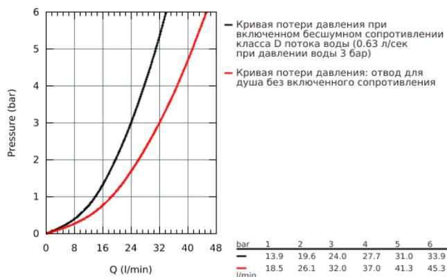
— Кривая потери давления при включенном бесшумном сопротивлении класса D потока воды (0.63 л/сек при давлении воды 3 бар)
