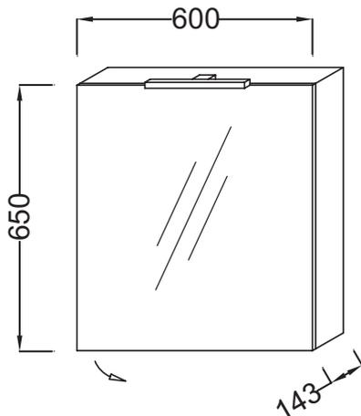
Спецификация продукта: Зеркальный шкаф 60 см. EB795DRU. Коллекция: ODEON UP. РАЗМЕРЫ (СМ): 60 x 14 x 65 см. ВЕС: 14,3 кг. МЕСТО ДЛЯ ХРАНЕНИЯ: 1 дверца с двойным зеркалом. ВКЛЮЧЕНИЕ: 230В, 3.5Вт, класс II, IP 44. РЕШЕНИЕ ХРАНЕНИЯ: Дверцы. МОДЕЛЬ: Правосторонняя. Правосторонняя: шарниры справа. Лакированное покрытие: внутренняя сторона серого цвета. Матовое покрытие: внешние и боковые панели.
