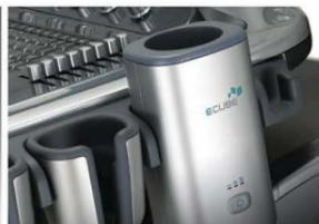
**Держатели для датчиков.** Во избежание повреждений датчиков во время эксплуатации на консоли расположены повторяющие форму датчиков специализированные держатели.
