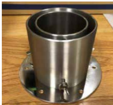
Двойной фланец для забора большого потока воздуха Диаметр 95 мм., Высота 105 мм.
