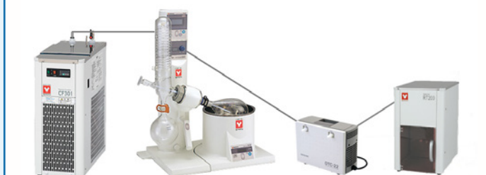
CF301 + RE Ротационный испаритель + RT200 + вакуумный насос
