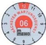
Указатель месяца, в котором требуется техническое обслуживание, обращен вверх (положение на 12 часов). На представленной наклейке это декабрь 2006 года.
