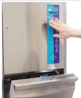
Все модели АТ (с автоматической дверцей) оснащены датчиком, который позволяет автоматически открывать и закрывать дверцу моечной камеры. В зависимости от предварительной настройки моечно-дезинфицирующей машины программа очистки запускается после закрытия дверцы автоматически.
