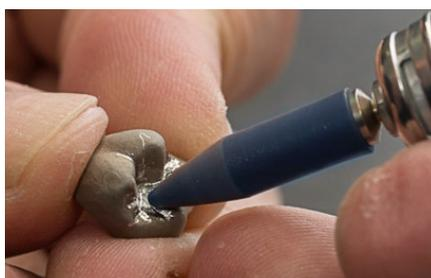
Крупнозернистый и твердый полир **9669M** идеально подходит для первого этапа полировки для сглаживания щечных и окклюзионных поверхностей. Перед первым использованием этому полиру должна быть придана нужная форма.
