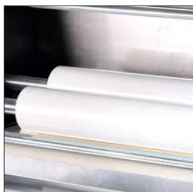
Три раскаточных валика из пищевого полиэтилентерефталата
