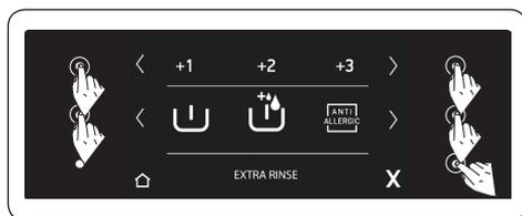
Используйте эту функцию, если требуется дополнительное полоскание белья. Машина оснащена 3 различными параметрами этой функции.
