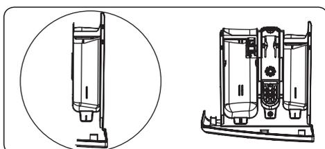
Это отделение используется только в режиме предварительной стирки. Программу предварительной стирки
