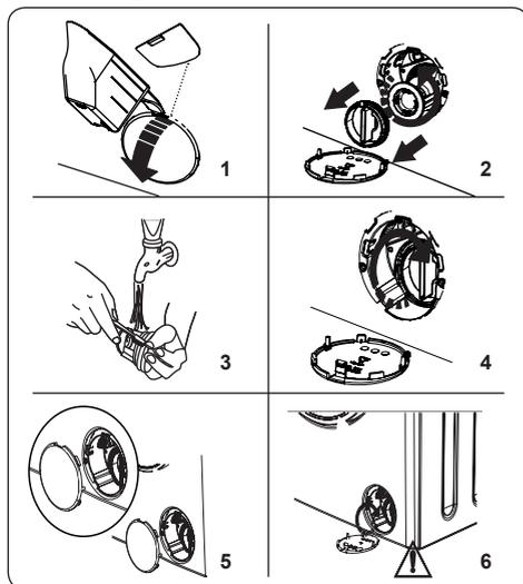
Фильтровальная система насоса машины продлевает срок службы насоса, предотвращая попадание ворсинок в машину. Рекомендуется очищать фильтр насоса раз в 2 месяца.
