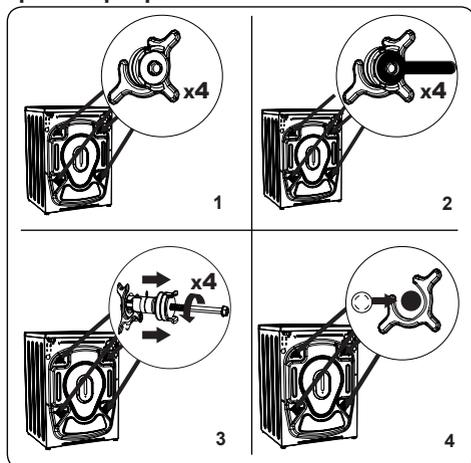
1. Перед использованием стиральной машины необходимо удалить 4 транспортировочных болта и резиновые прокладки в задней части машины. Если болты не удалены, они могут вызвать сильную вибрацию, шум и неисправность машины либо привести к недействительности гарантии.
