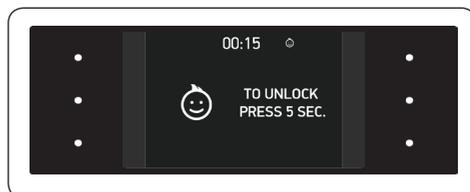
Если активна блокировка и выполняется любая программа, эта программа возобновится, даже при выключении машины нажатием кнопки включения/выключения.
