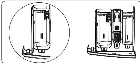
Используйте это отделение только для моющих средств (жидких или порошкообразных) и средств для удаления накипи. При первой установке внутри машины вы найдете мерную пластину для жидких моющих средств (\*)
