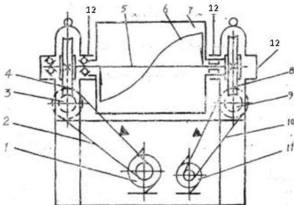
Принцип действия тестомесильной машины — емкость для приготовления теста (дежа) имеет горизонтальный вал, на котором размещены лопасти в форме S или Лопасты. За счёт вращения лопастей происходит смешивание продуктов и приготовление теста. Степень приготовления оператор определяет визуально.
