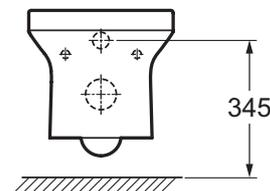
Спецификация продукта : Чаша подвешного унитаза без обода. EDX114RU. Коллекция : ELITE. РАЗМЕРЫ (CM) : 50 x 36 см. ВЕС : 23 кг. МАТЕРИАЛ : N/A. ТИП УСТАНОВКИ : Подвешная. TYPE DE BRIDE : Без обода. АВАНТАЖ : крышка - сиденье в комплекте. GARANTIE DE LA CÉRAMIQUE : 25 лет. CONDITIONNEMENT : Единая упаковка. FIXATION DE LA CUVETTE : Скрытые. NOUVEAUTÉ : 0. крышка-сиденье и крепления в комплекте.
