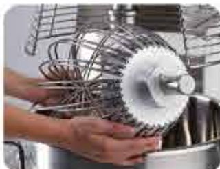
Estrazione utensile senza togliere la vasca Tool removal without bowl removal Extraction outil sans enlever la cuve Extracción del utensilio sin quitar la perol Herausnahme des Arbeitsgeräts ohne Entfernung des Kessels
