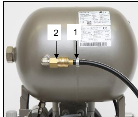
Рис. 4: Подключение к выпускному воздуховоду сжатого воздуха
