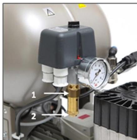
Рис. 7: Проверка предохранительного клапана
