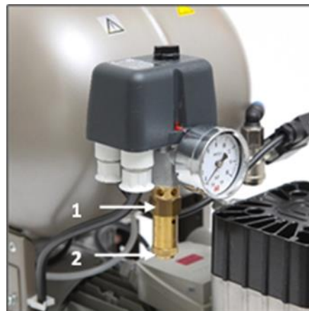
Obr. 7: Kontrola poistného ventilu
