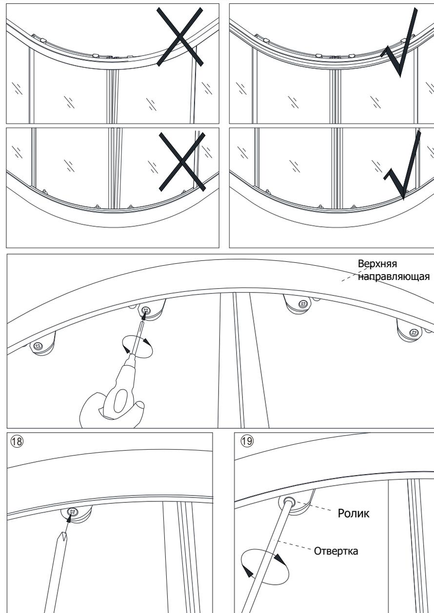
6.1) Пожалуйста, установите ролики раздвижной двери в алюминиевую направляющую. Если середина 2-х раздвижных дверей находится не по вертикали или, если после установки магнитной ленты между 2-я дверьми имеется зазор, следует отрегулировать винт на роликах с помощью отвертки, чтобы 2-е сдвижные двери плотно прилегли друг к другу
