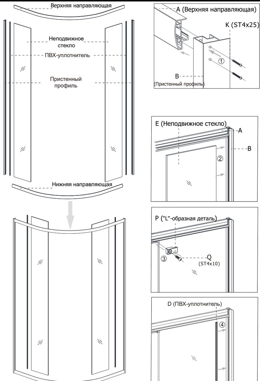
3.1) Пожалуйста, вставьте зажим для стекла в направляющую из алюминиевого сплава (возможно, он уже закреплен на ней), затем вставьте ПВХ-уплотнитель на неподвижное стекло.
