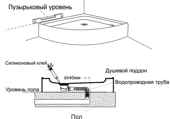
2.2) Проверьте сливное отверстие на предмет утечки воды; если оно пропускает воду, используйте, пожалуйста, силиконовый клей для его герметизации.
