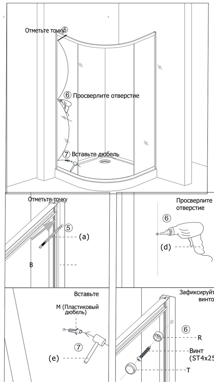
4.1) Приложите профиль в нужное место, сделайте отметку для будущего отверстия, затем отложите профиль в сторону, сделайте отверстия в стене, вставьте пластиковый дюбель и прикрепите его к стене винтом (ST4x25).
