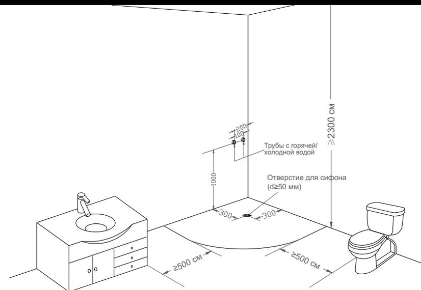
2.1) Сливное отверстие: для надлежащего отвода воды постарайтесь установить сливное отверстие в верхнем положении; если это не представляется возможным, слив должен находиться как минимум на высоте 20 мм, диаметр сливного отверстия должен быть менее 40 мм.
