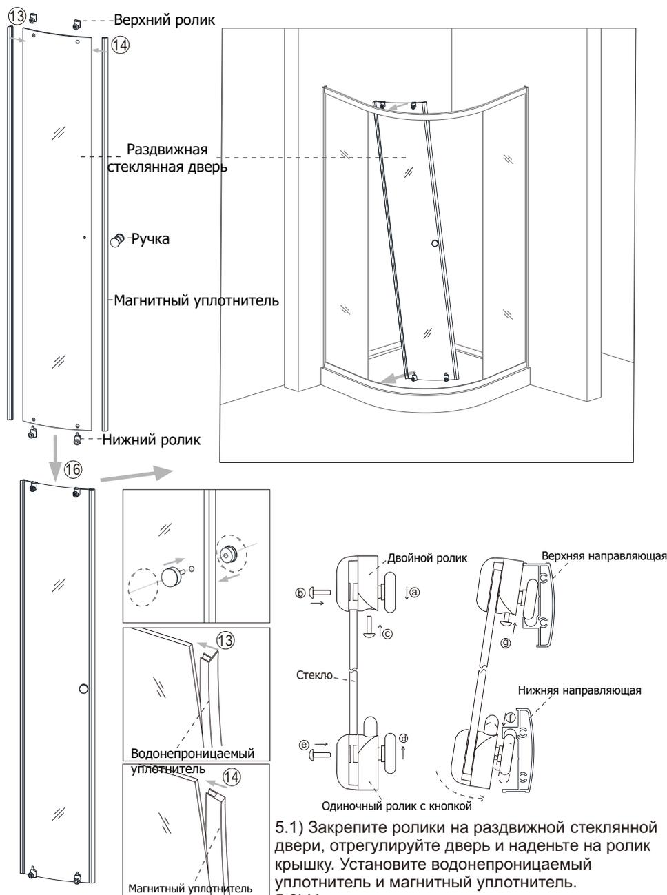
5.1) Закрепите ролики на раздвижной стеклянной двери, отрегулируйте дверь и наденьте на ролик крышку. Установите водонепроницаемый уплотнитель и магнитный уплотнитель.
