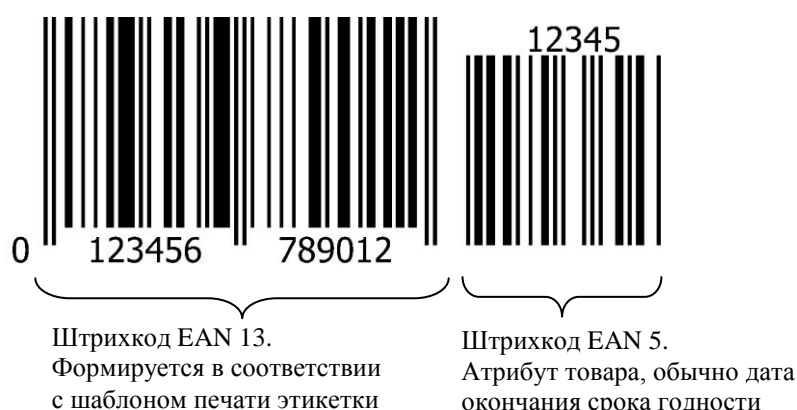
Рис. 7.2 – Структура штрихкода EAN 13+5
