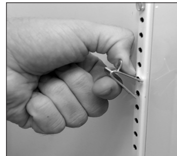
Рис. 2. Нижняя часть кронштейна должна зафиксироваться.
