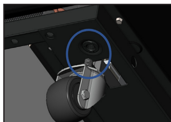
Рис. 6. Ослабить затяжку болта роликовой опоры.
