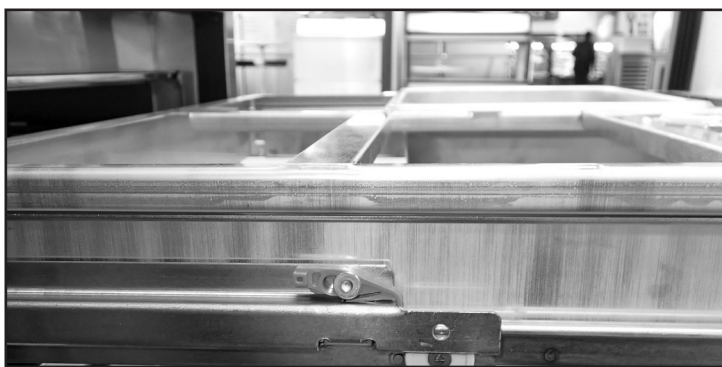
Рис. 1. Местонахождение фиксатора ящика. Фиксатор введен в зацепление.
