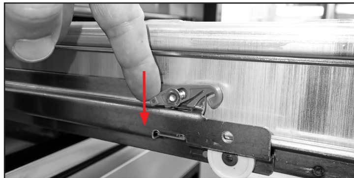
Рис. 2b. Подать заднюю часть фиксатора вниз.
