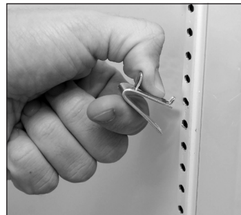
Рис. 1. Установка верхнего язычка кронштейна под полку.
