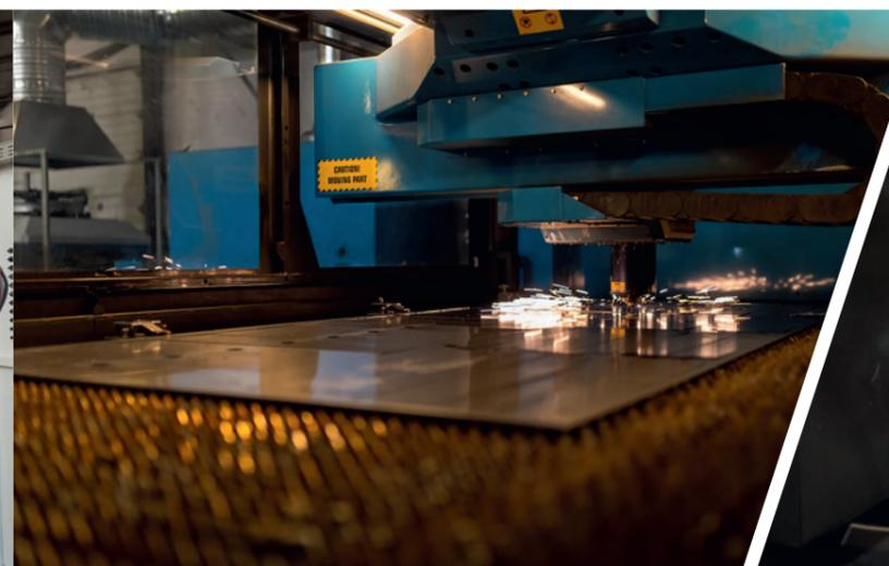
Лазерный станок позволяет вырезать сложные детали.
