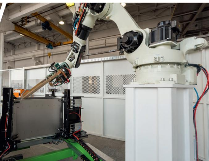
В цеху работают три сварочных комплекса. Эти роботы обеспечивают высокую скорость и точность сварки.
