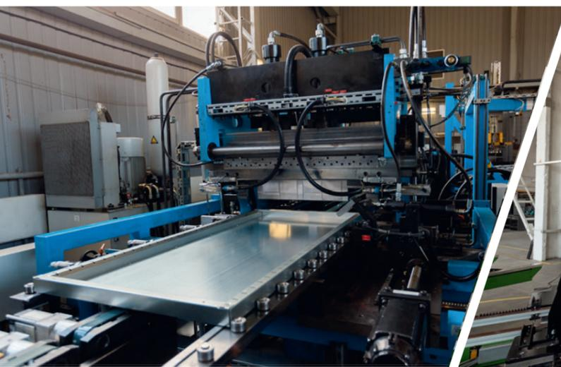
Стеллажи изготавливаются на станках полного цикла. Длина станка — 56 метров. Производительность — 12 полок в минуту.
