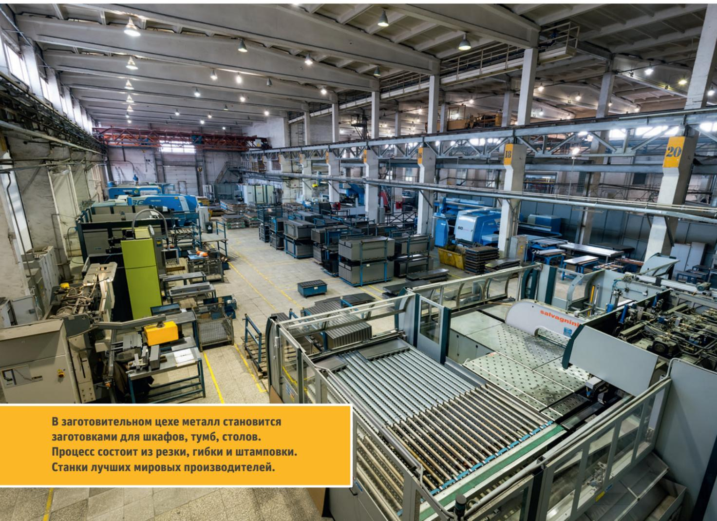
В заготовительном цехе металл становится заготовками для шкафов, тумб, столов. Процесс состоит из резки, гибки и штамповки. Станки лучших мировых производителей.
