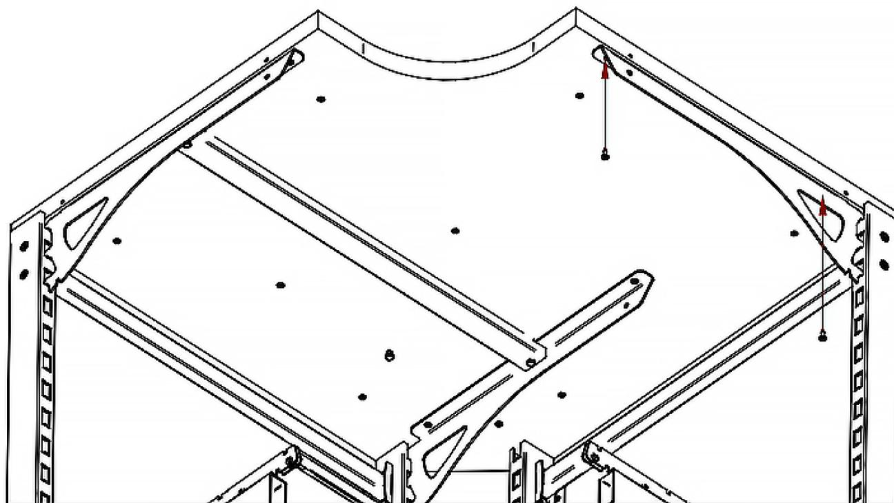
Заключительным этапом сборки кассового модуля является установка боковин, аналогично как в установке на прямой модуль.
