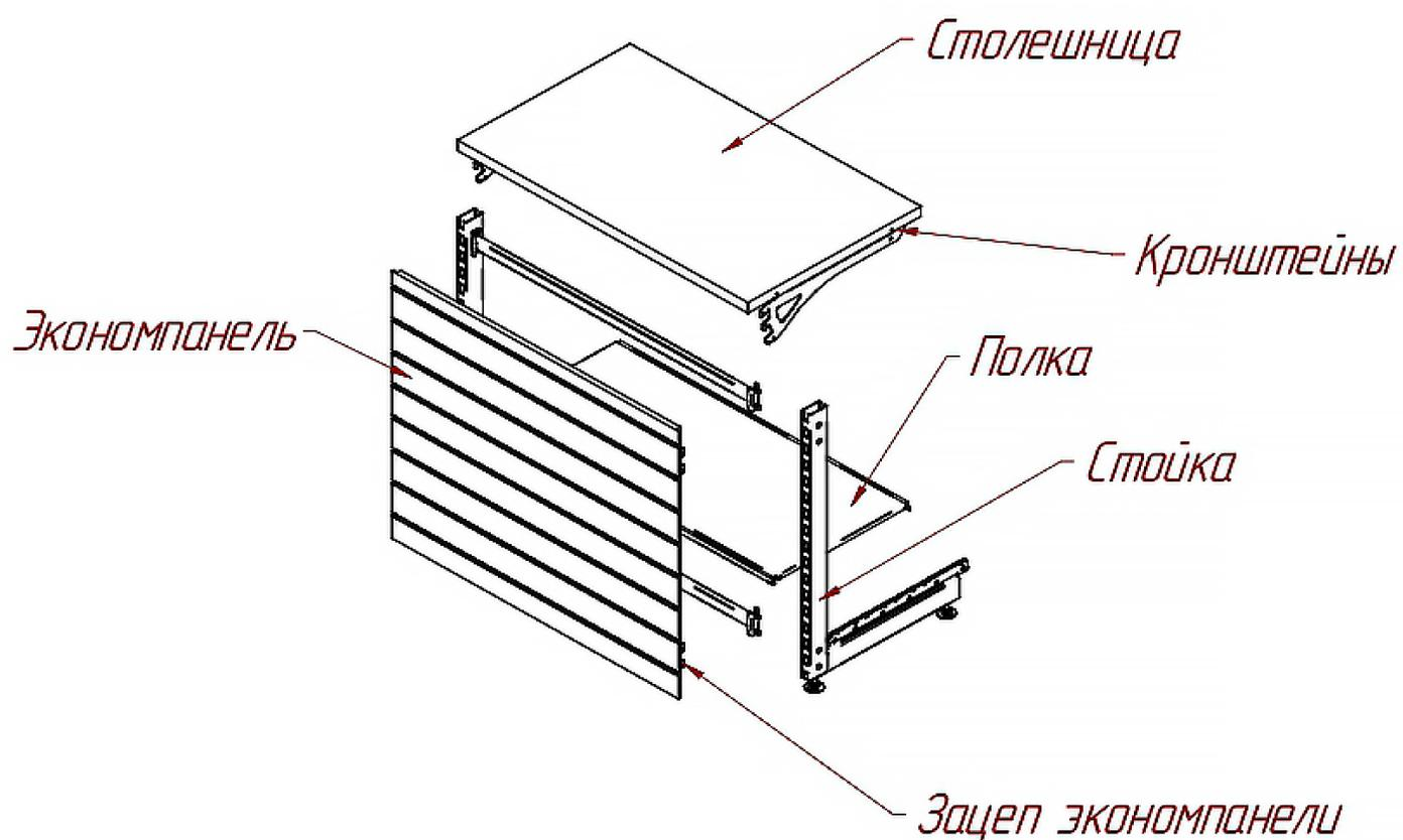
1. Соединить стойки траверсами с помощью винтов, входящих в комплект.
