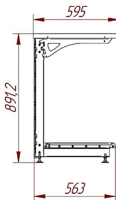
При сборке кассовых модулей в ряд, стойка предыдущего модуля является опорой для крепления траверс последующего.
