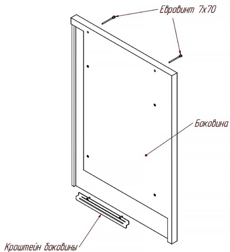
Крепим кронштейн боковины к боковине кассового модуля самонарезающими винтами. В месте крепления расположены наметочные отверстия.
