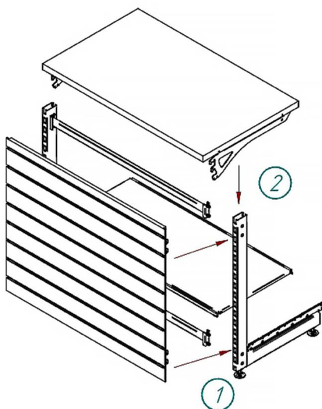
Если в состав модуля входит боковина и модуль считается собранным, нужно установить боковины кассового модуля.
