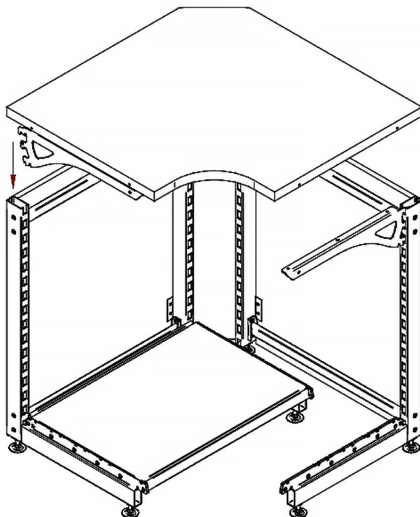
6. Закрепить столешницу к третьему кронштейну снизу либо винтами самонарезающими, либо винтом в футорку, установленную в столешницу сквозь кронштейн.
