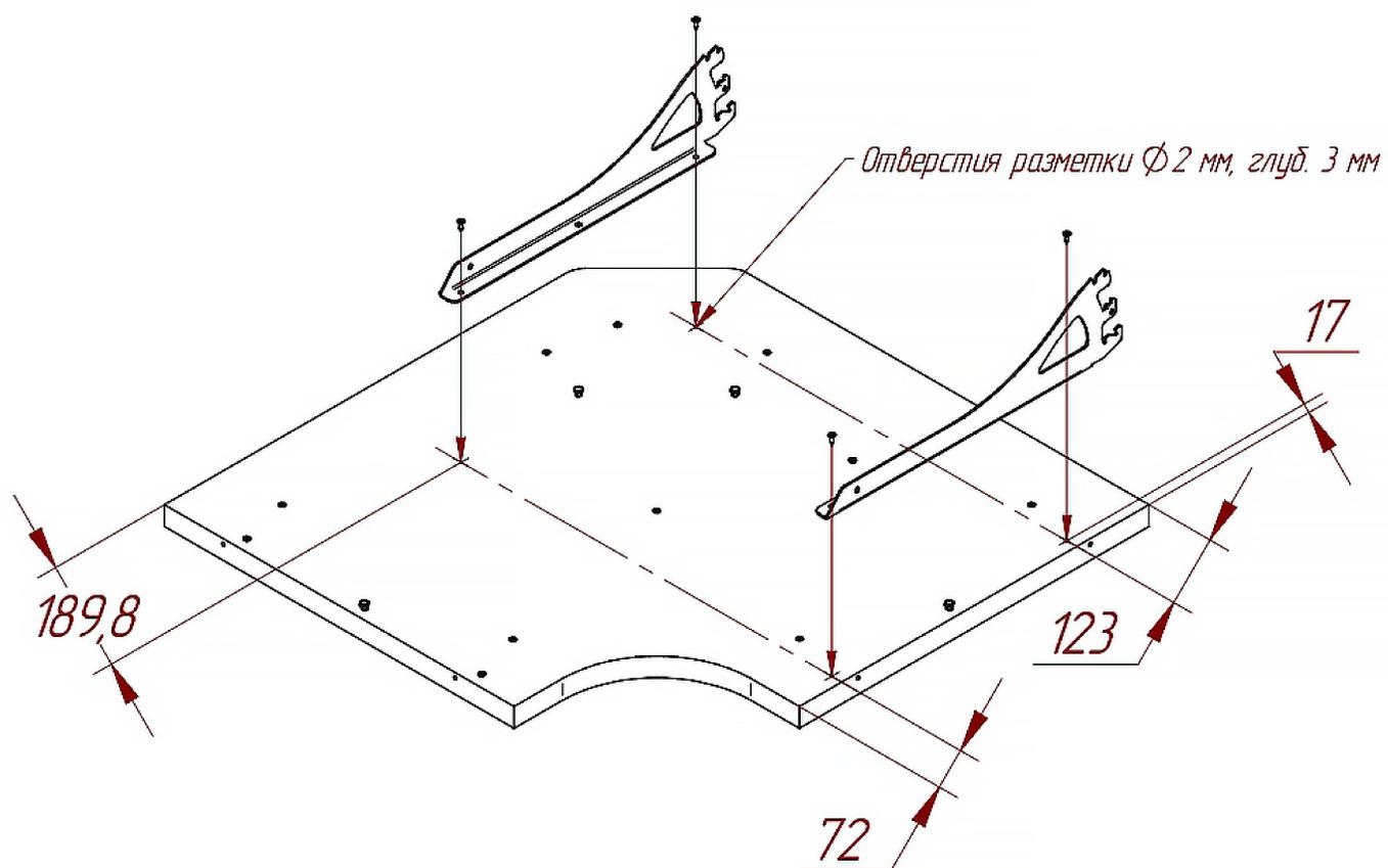
5. На стойки навесить третий кронштейн угловой столешницы, также навесить столешницу с закрепленными кронштейнами.
