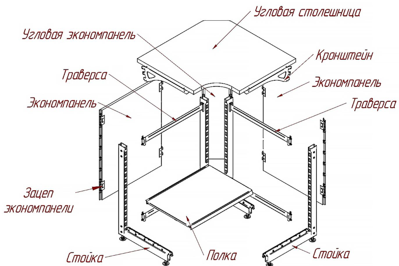
Если за прямым модулем следует угловой, собирать его как продолжение прямого. Также возможно начать сборку с углового модуля, продолжив его прямым.
