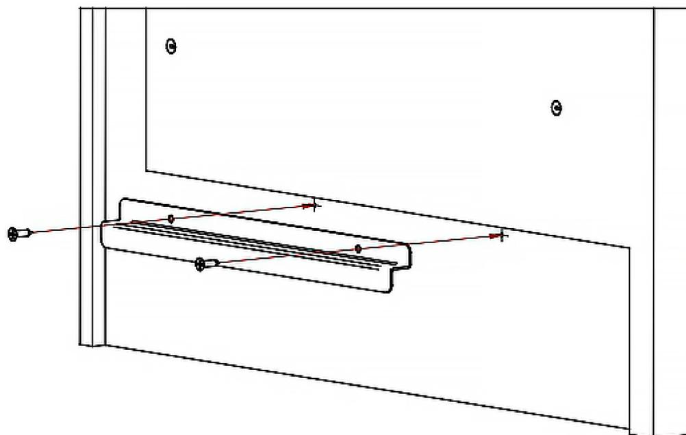
Для установки боковины нужно завести кронштейн боковины между щечками базы. Для фиксирования верхнюю часть боковины закрепить к столешнице евровинтами 7x70.
