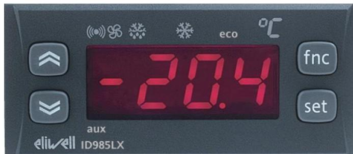
Рис. П2-1. Лицевая панель контроллера **ID 985 LX/K**
