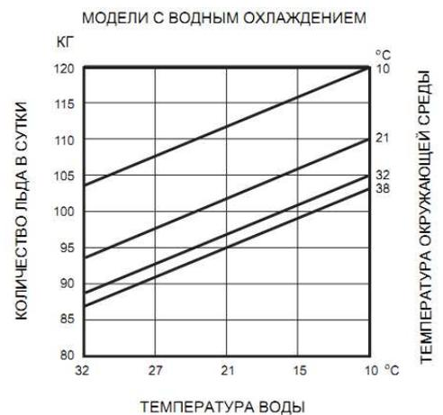
**ПРИМЕЧАНИЕ.** Суточная производительность льда напрямую связана с температурой воздуха на входе конденсатора, температурой воды и возрасте прибора. Для поддержания максимальной производительности льдогенератора SIMAG периодические технические проверки должны проводиться в соответствии с разделом «Техническое обслуживание» настоящего руководства.
