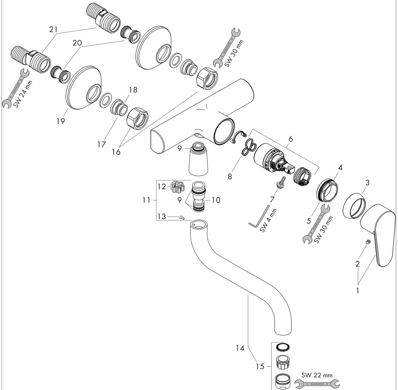
**Focus M41****Кухонный смеситель однорычажный, 320, настенный, с низким изливом, 1jet**Поверхности : **хром** Артикульный номер: **31825000**
