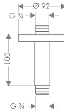
Потолочное подключение 100 мм, 3/4"
