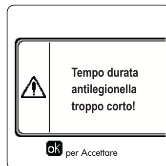
fig. 27 - Messaggio Funzione antilegionella non conclusa
