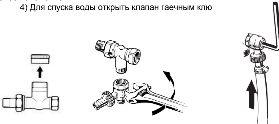
Рис. 3. Монтаж спускного крана.
