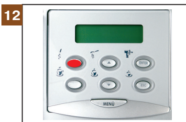
12 Нажмите кнопку для начала приготовления кипятка, нажмите повторно, когда струя воды станет устойчивой
