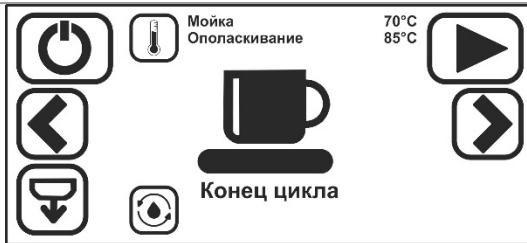
Когда на дисплее отобразится "Конец цикла", то после открытия дверцы/капота посудомоечная машина будет готова к следующему циклу мойки.
