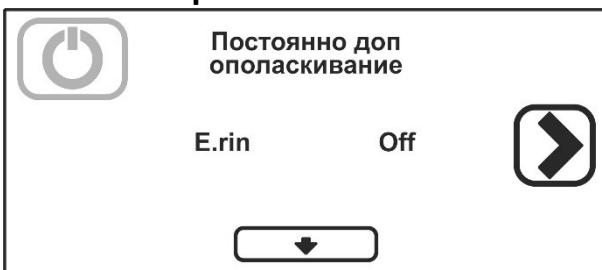
Ополаскивание продлевается на 10 секунд по сравнению со стандартным циклом при каждой мойке.
