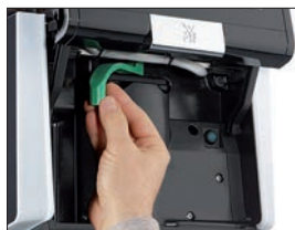
Повернуть фиксатор на 180°
