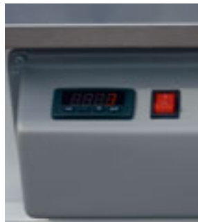
панель с микропроцессорным блоком управления
