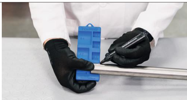
Рис. 28. Маркировка глубины вставки.
