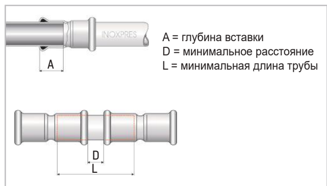
Рис. 27. Глубина вставки и минимальные размеры.
