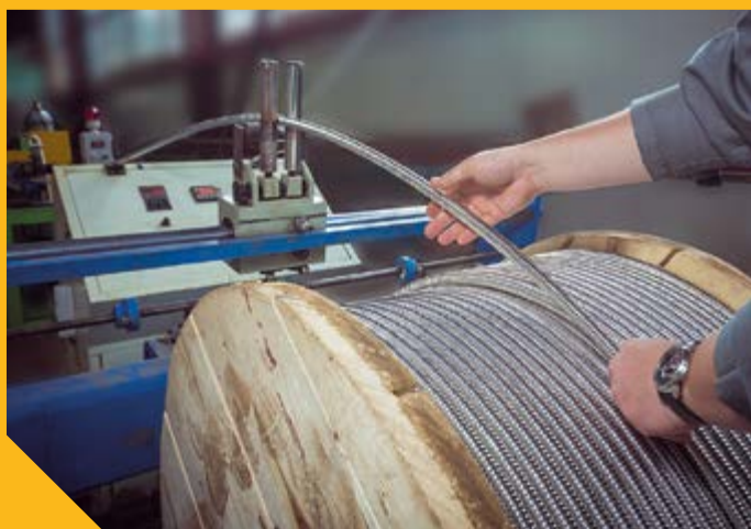
Подача гофрированной трубы Stahlmann для отжига
