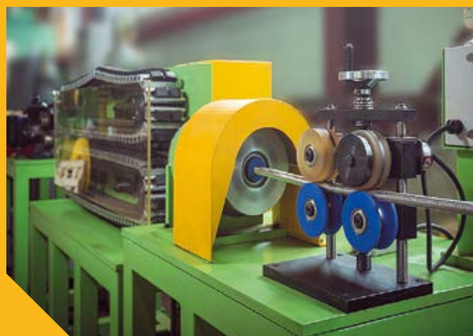
Процесс гофрирования трубы
