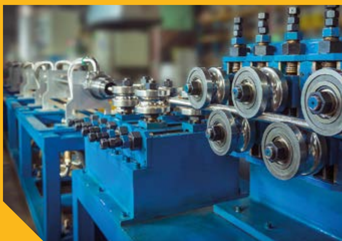
Линия охлаждения гофрированной трубы Stahlmann после отжига
