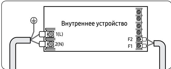
2 Панель (дисплей) должна быть подсоединенна ко внутреннему устройству для получения опции.
