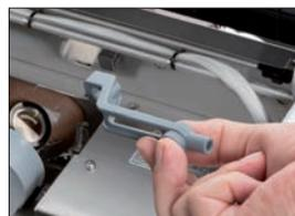
Повернуть фиксатор на 90°
