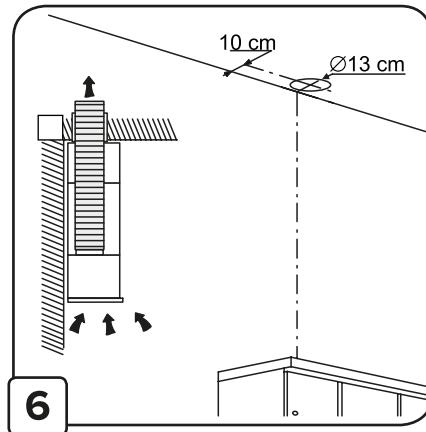
Все модели серии Crosby устанавливаются в кухонный шкафчик при помощи крепежных элементов, помещенныхных в коробке с изделием.
