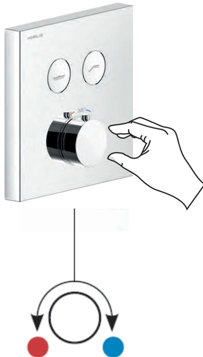
Tutti i miscelatori termostatici vengono collaudati posizionando temperatura a 38° tramite pulsante di sicurezza: qualora viene desiderata una temperatura più elevata spingendo il bottone e ruotando in senso antiorario la maniglia si possono ottenere temperature maggiori.
