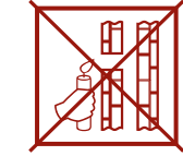
недостаточная тяга (Не используйте котел!)
