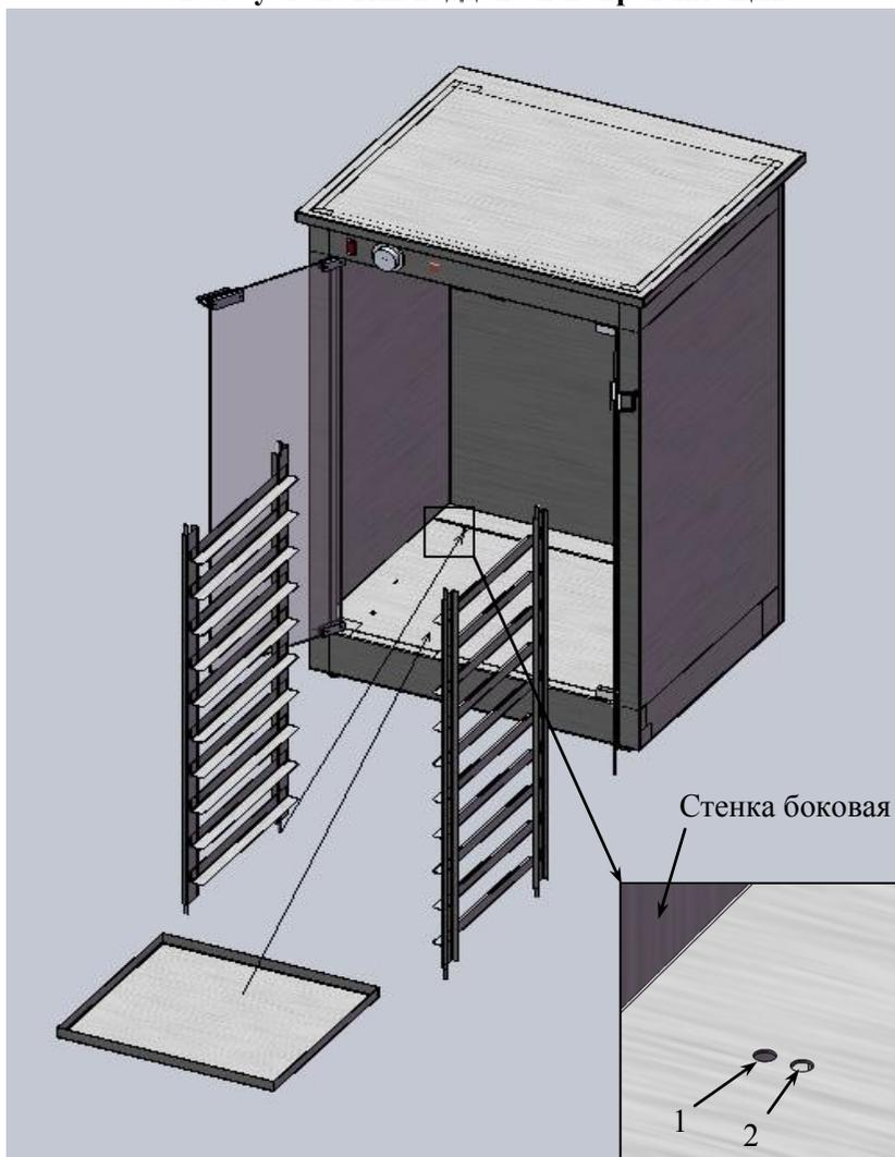
При транспортировке направляющие и поддон закрепляются к задней стенке шкафа расстоечного с наружной стороны шкафа.
