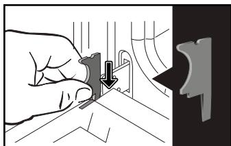
Vyjmutí prvního skla dveřek: Pomocí nástroje (šroubováku) zatlačte na drážky (**A**) abyste odepli skleněnou tabuli a poté ji vyjměte.
