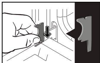
Zdejmowanie pierwszej szyby drzwi: Za pomocą narzędzia (śrubokrętu) naciśnij rowki (**A**), aby odciągnąć szybę, a następnie ją wyjąć.
