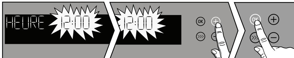
Čas nastavte pomocou tlačidla + alebo -. Nastavenie potvrdťte pomocou tlačidla **OK**.
