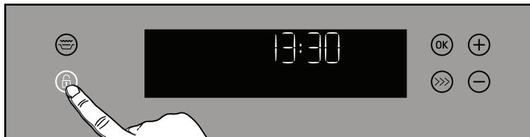
Aby odblokować, przytrzymaj przycisk ponownie, aż symbol zniknie z wyświetlacza.
