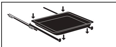
Chcete-li vyjmout kolejničky, znova vyjměte regálové lišty. Mírně od sebe oddělte spodní část úchytek připevněných na každé kolejničce, aby se uvolnily.
