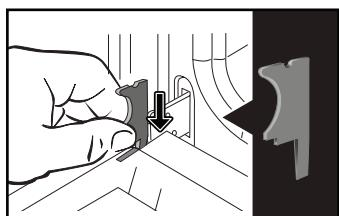
Az első ajtóüveg eltávolítása: a szerszámmal (csavarhúzával) nyomja meg a hornyokat (**A**) az üveglap kioldásához, majd távolítsa el azt.
