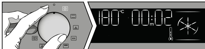
Nárast teploty začne okamžite. Indikátor času vám oznámi, ako dlho je rúra v prevádzke. Rúra sa zohrieva a indikátor teploty bliká. Ked' rúra dosiahne naprogramovanú teplotu, zaznie séria zvukových signálov.
