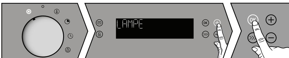
Stlačením tlačidla **OK** potvrďte svoju voľbu. Pomocou tlačidiel + a - aktivujte alebo deaktivujte rôzne parametre, pozrite si tabuľku.
