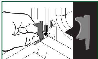
Entfernen Sie die erste mit Clip befestigte Scheibe:
