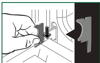
Pressione com a ajuda de uma ferramenta (aparafusadora) nos encaixes **A** para retirar o vidro. Retire o vidro.
