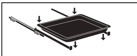
Demontera skenorna genom att åter ta ut ugnsstegarna.
