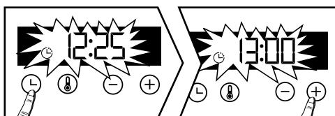
Displayen blinkar för att ställa in tiden för slutet av tillagningen med + eller -. Tiden för avslutad tillagning sparas automatiskt efter några sekunder. Displayen med tiden för avslutad tillagning slutar blänka.
