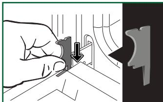
Verwijder de eerste geknipte ruit: druk met een stuk gereedschap (schroevendraaier) op de plaatsen (A) om de ruit los te klikken en verwijder hem.
