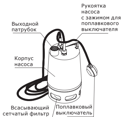
Рис. 1 Конструкция насосов APV.06 / APV.40 V
