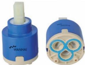
**Надежные керамические картриджи WANHAI** диаметром 35 мм и 40 мм. Картридж устойчив к истиранию, обеспечивает герметичность и длительный срок службы изделия, рассчитан на 500 000 циклов использования. Защищен от известкового налета, работает, практически, бесшумно.
