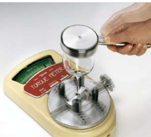
Prova resistenza stelo alla torsione - Stem twisting test
