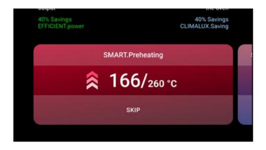
UNOX рекомендует использовать SMART. Preheating, автоматический подогрев, самостоятельно устанавливающий время и температуру подогрева; он учитывает рассеивание тепла при открытии дверцы и адаптирует камеру печи к новым параметрам при переходе от одного цикла приготовления к другому.
