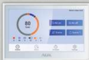
Центральный пульт управления CC-02
